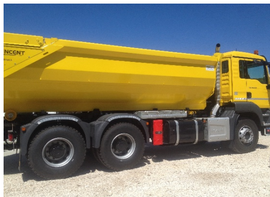
Camion PL équipé d'une benne TP
